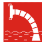
F 07 ПОЖАРНЫЙ ВОДОСТОЯННИК
