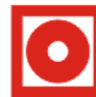
F 10 МЕСТО ВОЗМОЖНОЙ УСТАНОВКИ ПОЖАРНОЙ АВТОМАТИКИ
